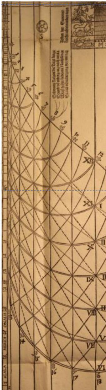
Les échelles de midi sont des échelles en latitude. Celle de l'horoscopion est de degré en degré de 0° à 67° et celle du folium populi est de degré en degré de 0° à 77°.
