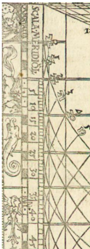
Fig. 7. Haut de l' échelle de midi , SCALA MERIDIONALIS. Sur sa droite, des lignes parallèles d'heures à égales distances avec des doubles traits et sur sa gauche, une colonne intitulée QUARTALIA, pour signifier que chaque heure est divisée régulièrement en quatre.
