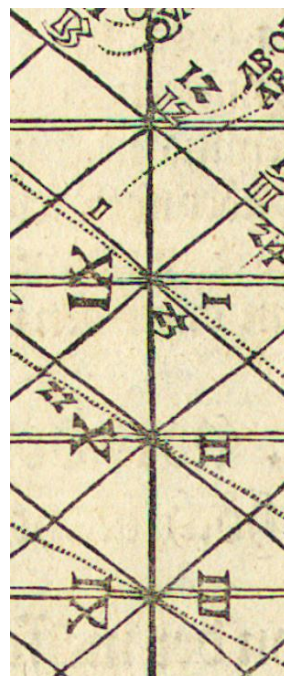
Fig. 16. Les lignes en pointillé sont les lignes d'heures planétaires I XI, II X, III IX, ... La ligne XII est la ligne horizon .
