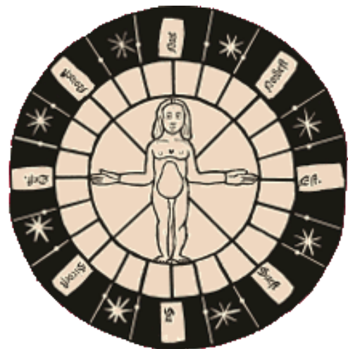
Fig. 6. Roue du pôle - homme avec le nom des 8 principaux rhumbs et aussi un découpage en 24 heures Le "nord" 8 est en haut. Grant routtier , Pierre Garcie dit Ferrande, 1520
