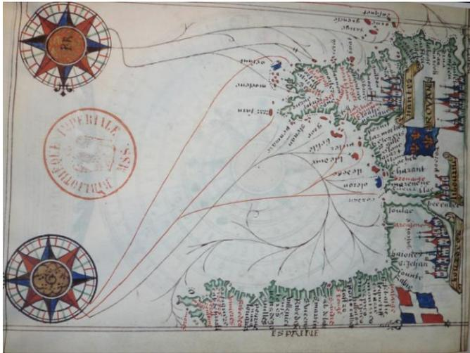
Fig. 3. Situations des ports, en rhumbs, dans le Golfe de Gascogne données à partir d'une rose des vents en suivant les «branches», du rhumb au port [Manuel de pilotage, à l'usage des pilotes bretons, Guillaume Brouscon, 1548, BnF](#)
