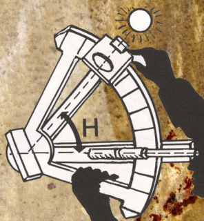
Un instrument intermédiaire entre le quartier anglais et l'octant D'après Randier
