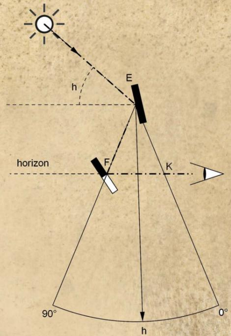
L'observation simultanée de l'horizon et du rayon réfléchi est réalisable grâce à un ingénieux dispositif placé en F : un miroir fixe qui réfléchit le Soleil juxte un verre translucide qui permet l'observation directe de l'horizon. Si l'astre observé est le Soleil, on déplace l'alidade pour que le Soleil soit tangent à l'horizon.
