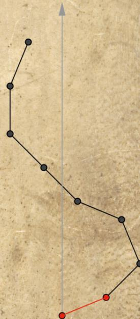
Un exemple : à la fin d'un quart de 4 heures, les poules sont disposées comme sur le dessin. En supposant la vitesse constante, on peut estimer le chemin du navire.
