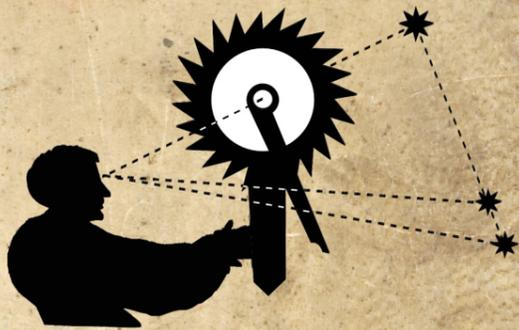
On règle l'index de 12 h du disque mobile sur la date du jour de l'observation. Par le trou central, on vise la Polaire en tenant verticalement l'instrument par la poignée à bout de bras. Puis on tourne l'alidade dans la direction des Gardes, elle indique l'heure sur le disque mobile.
